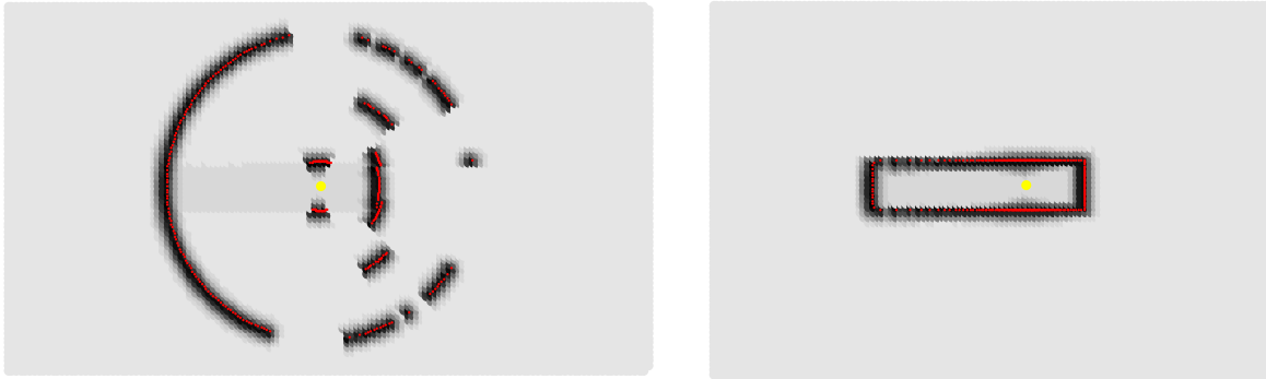
Figura 4.3: Representación de la función de densidad de las lecturas del sonar, p(z_i | \mathbf{x}) , para una posición (x, y) fija del robot en un entorno de final de pasillo centrado en la posición en la que se han tomado las lecturas. A la izquierda nuestro modelo, a la derecha el modelo de (Burgard, Cremers, Fox, Hahnel, Lakemeyer, Schulz, Steiner, y Thrun 1998).
